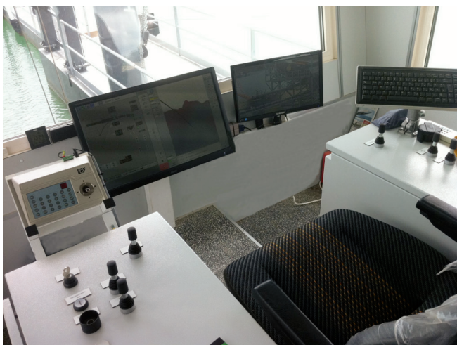
STEUERN UND VERSORGEN: Die modern ausgestattete Steuerkabine enthält den Steuerstand und einen Teil der Automatisierungstechnik. Bedienkabine und Elektorraum sind völlig unabhängig voneinander voll klimatisiert.
