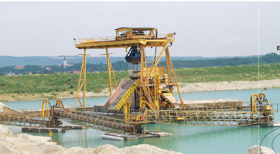
**SCHWIMMGREIFERANLAGE** in Grafenwörth im Einsatz der Cemex Austria AG.
