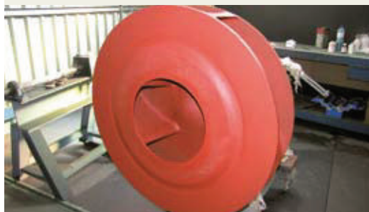
Nach den erfolgten Schweißarbeiten erhielt das Laufrad eine fachlich korrekte Untergrundvorbereitung als Basis für den Erfolg der Beschichtung.
