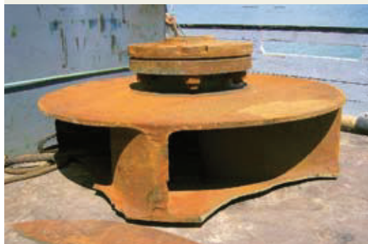
Pumpenlaufrad mit Bruchschaden – Alter unbekannt. Reparatur und Schutzbehandlung sollten es wieder einsatzbereit machen.
