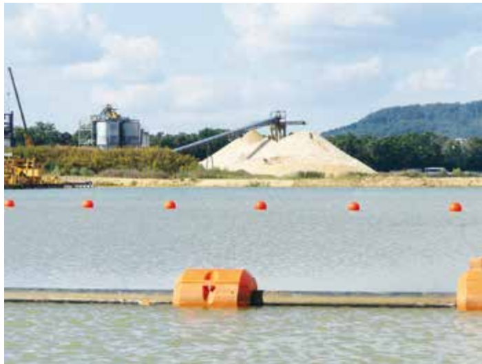
GESCHLOSSENER ANSATZ: Die Sand-Wasser-Suspension wird vom Saugbagger per Rohrleitung zur ersten und von dort weiter zur zweiten Aufbereitungsstufe transportiert.
