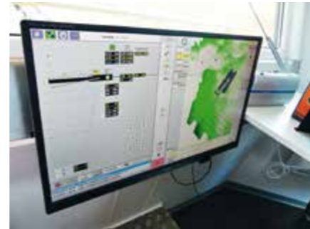
ALLES IM BLICK: Der Saugbaggerführer kann dank Komplettnetzwerk von Gewinnung und Aufbereitung durch die Team GmbH nicht nur Gewinnungszustände, sondern auch die Aufbereitung kontrollieren. Zudem ist der Betreiber per RemoteControl mit den Softwarespezialisten vernetzt.
