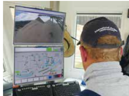
ALLES IM BLICK: Der Saugbaggerführer kann dank Komplettnetzwerk von Gewinnung und Aufbereitung durch die Team GmbH nicht nur Gewinnungszustände, sondern auch die Aufbereitung kontrollieren. Zudem ist der Betreiber per RemoteControl mit den Softwarespezialisten vernetzt.
