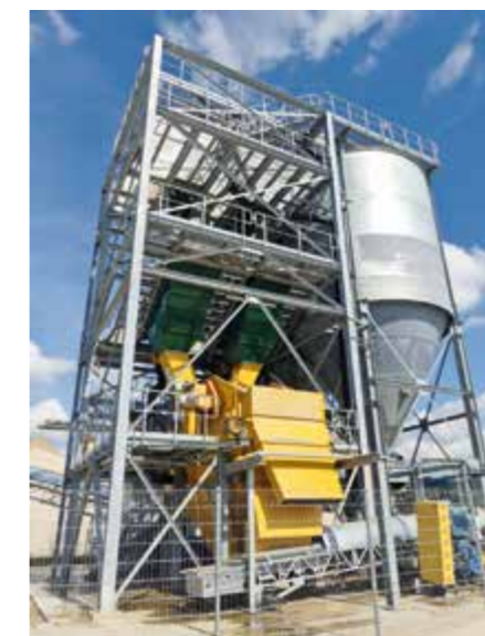
ZWEI AUFBEREITUNGSSTUFEN: Zuerst werden Grobkorn > 2 mm, oft verbacken mit eisenhaltigen Verunreinigungen, sowie feinste Ton- und Schluffanteile abgetrennt. Im zweiten Schritt sorgen Zyklo- und zwei Stack-Sizer für sieblinientreue Spezialsandprodukte nach den Anforderungen der Betontechnologen.
