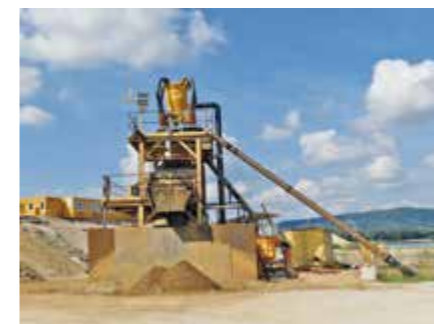
ZWEI AUFBEREITUNGSSTUFEN: Zuerst werden Grobkorn > 2 mm, oft verbacken mit eisenhaltigen Verunreinigungen, sowie feinste Ton- und Schluffanteile abgetrennt. Im zweiten Schritt sorgen Zyklo- und zwei Stack-Sizer für sieblinientreue Spezialsandprodukte nach den Anforderungen der Betontechnologen.
