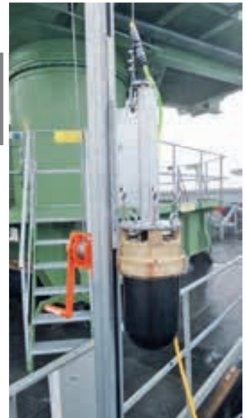
HALBRAUM-SONAR oder auch Dual-Axis-Sonar (DAS). Dieser Sensor kann den Seegrund in der Horizontalen im Bereich von 0 bis 360° abtasten. Der vertikale Abtastwinkel kann sich zwischen 0 und 90° bewegen.
