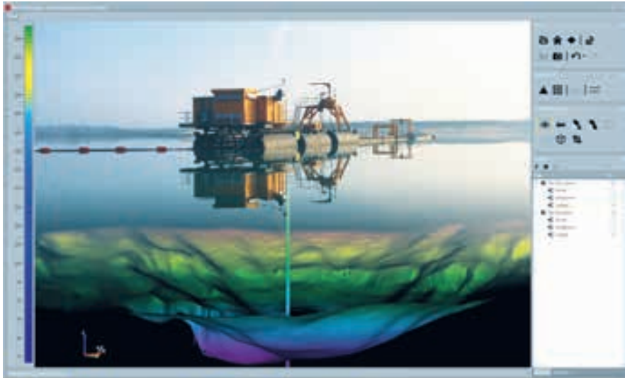
HALBRAUM-SONAR oder auch Dual-Axis-Sonar (DAS). Dieser Sensor kann den Seegrund in der Horizontalen im Bereich von 0 bis 360° abtasten. Der vertikale Abtastwinkel kann sich zwischen 0 und 90° bewegen.
