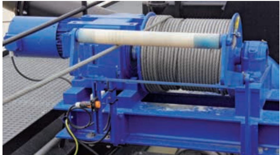
SAUGROHRWINDE: Ein Arbeitspunktregler kombiniert die Vakuumregelung für die Saugrohrwindenautomatik mit der Pressdrucküberwachung für die Sandpumpe.
