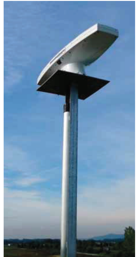
GPS-Gerät zur Bestimmung der Position des Schwimmgreifers.
